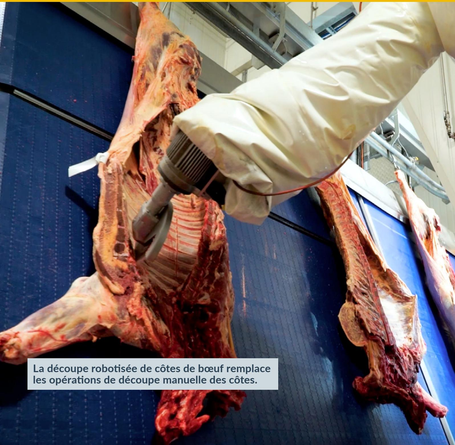
La découpe robotisée de côtes de bœuf remplace les opérations de découpe manuelle des côtes.
